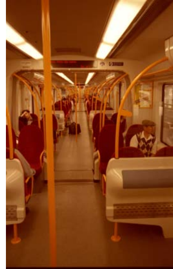
Fig.2 – Interior da Siemens-Bombardier. Deixa de haver risco e aventura na passagem entre carruagens. Ambiente aberto, condicionado e confortável, num serviço de qualidade certificado.
