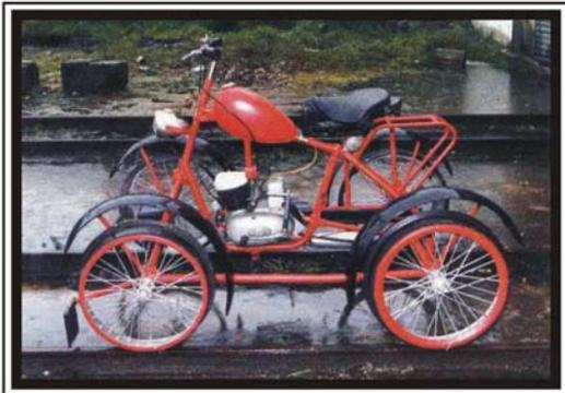
Quadrículo a motor, utilizado na inpecção da linha.
