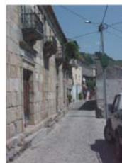
As casas são de construção em pedra e madeira e as paredes não apresentam qualquer tipo de reboco, geralmente a pedra mais utilizada é o granito, mas por vezes o xisto também é frequente.
